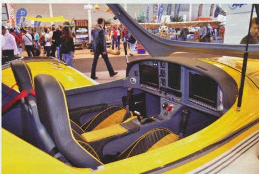
«Стеклопанельная» кабина Bristell LSA
