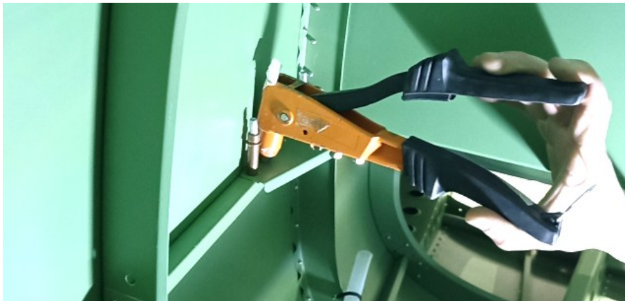
Fig. 9 Set the rivet
