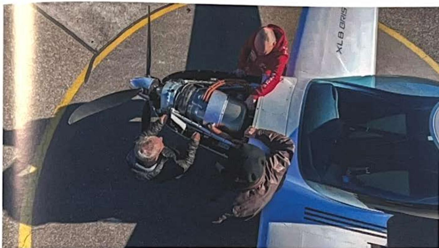
**La turbina** occupa quasi tutto il vano motore, si nota lo scambiatore di calore anulare esterno per il riscaldamento cabina
