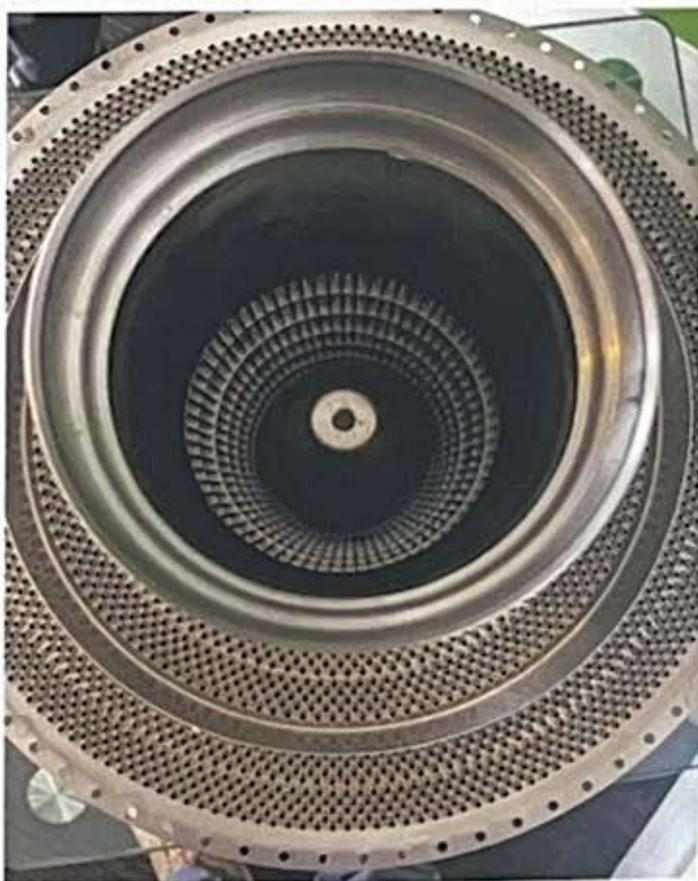
**Lo scambiatore di calore anulare** è costituito da centinaia di microtubi, un brevetto Turbotech
